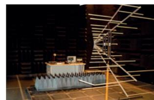
Prova di immunità in Camera Anecoica
