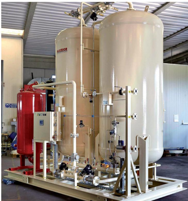
Skid di impianto per produzione di ossigeno (processo PSA)
